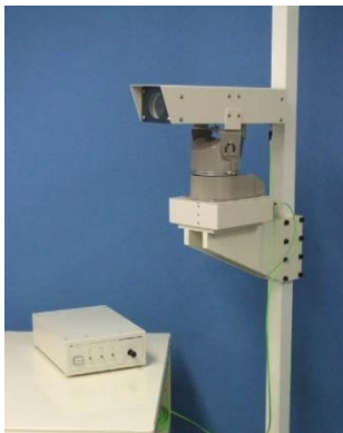
CCTVカメラを1台制御
