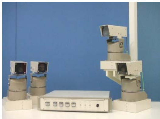
CCTVカメラを最大で4台まで制御
